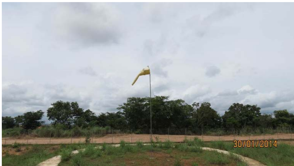
Figura 57 – Biruta Simples sem iluminação.
